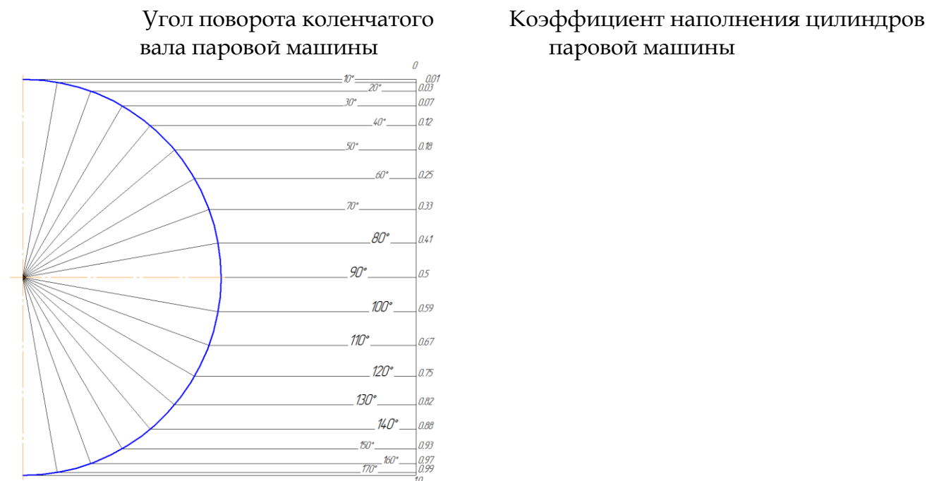
Рисунок 1. Зависимость коэффициента наполнения цилиндров от угла поворота коленчатого вала машины.
