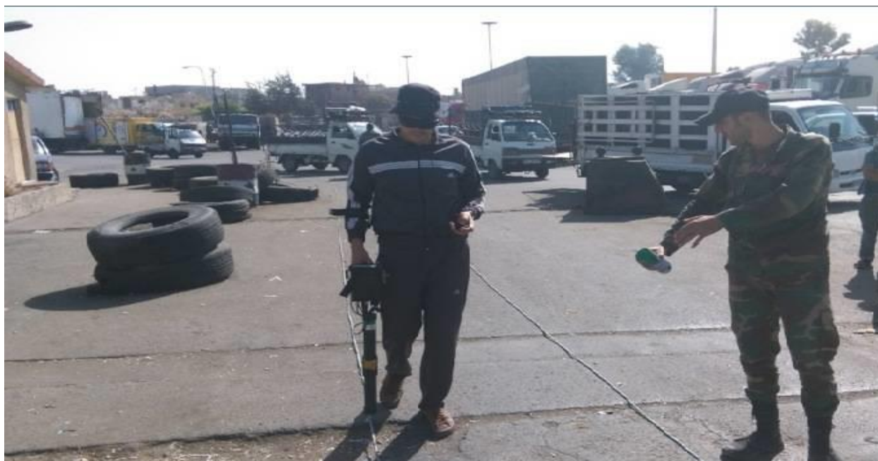
Рисунок 2. Использование георадара, для обнаружения тоннелей Ехр 5000. ( https://topwar.ru/134530-siriya-kontrtonnelnaya-borba.html )
