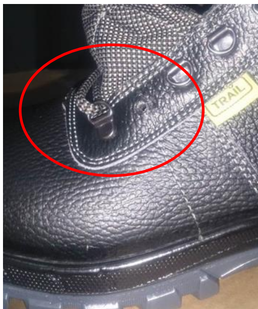
Рисунок 14. Пример дефекта «отсутствие фурнитуры»
