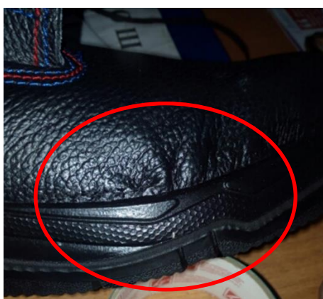
Рисунок 5. Пример дефекта «складки материала верха»
