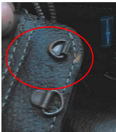
Рисунок 11. Пример дефекта «коррозия металлической фурнитуры»
