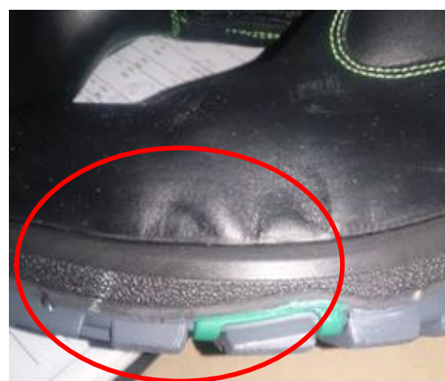
Рисунок 5. Пример дефекта «складки материала верха»
