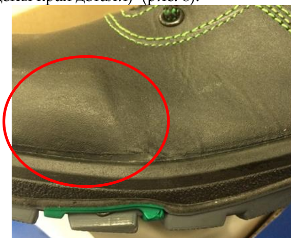
Рисунок 8. Пример дефекта «вылегание краев подноски»
