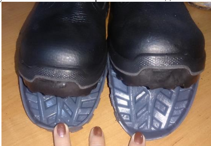
Рисунок 13. Пример дефекта «отклеивание подошвы в носочной части»
