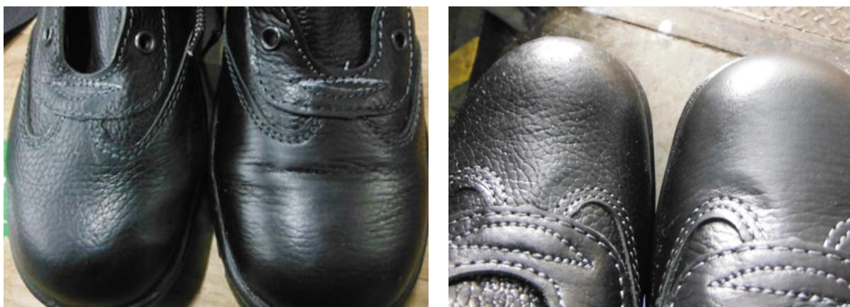
Рисунок 7. Пример дефекта «разный рисунок мереи одноименных деталей в паре»
