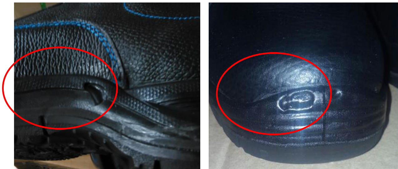
Рисунок 12. Пример дефекта «раковины на подошве»
