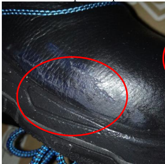
Рисунок 9. Пример дефекта «повреждение кожи верха»
