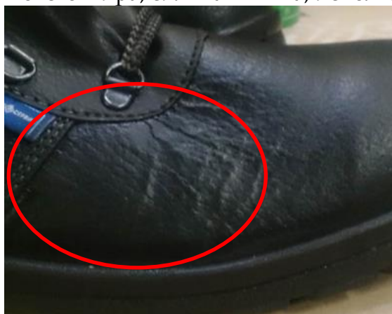
Рисунок 15. Пример дефекта «отдушистость кожи верха»
