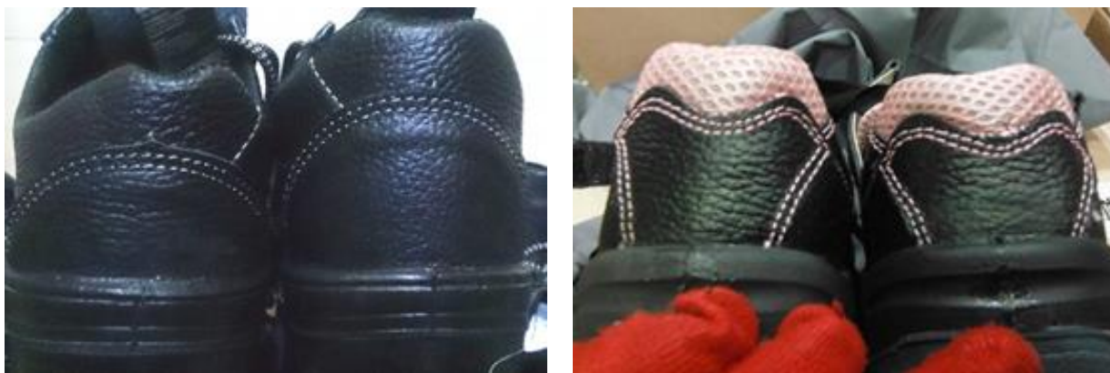
Рисунок 6. Пример дефекта «несоответствие одноименных деталей в паре»
