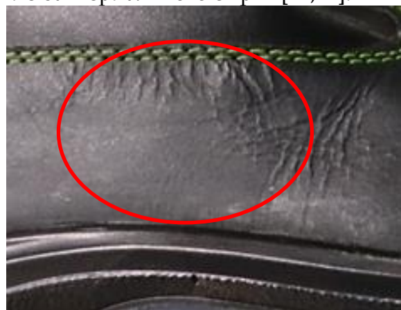
Рисунок 15. Пример дефекта «отдушистость кожи верха»
