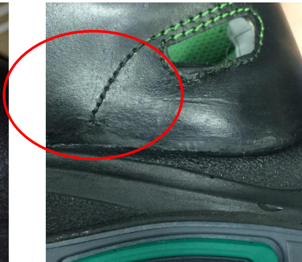
Рисунок 10. Пример дефекта «закрашенные нити»
