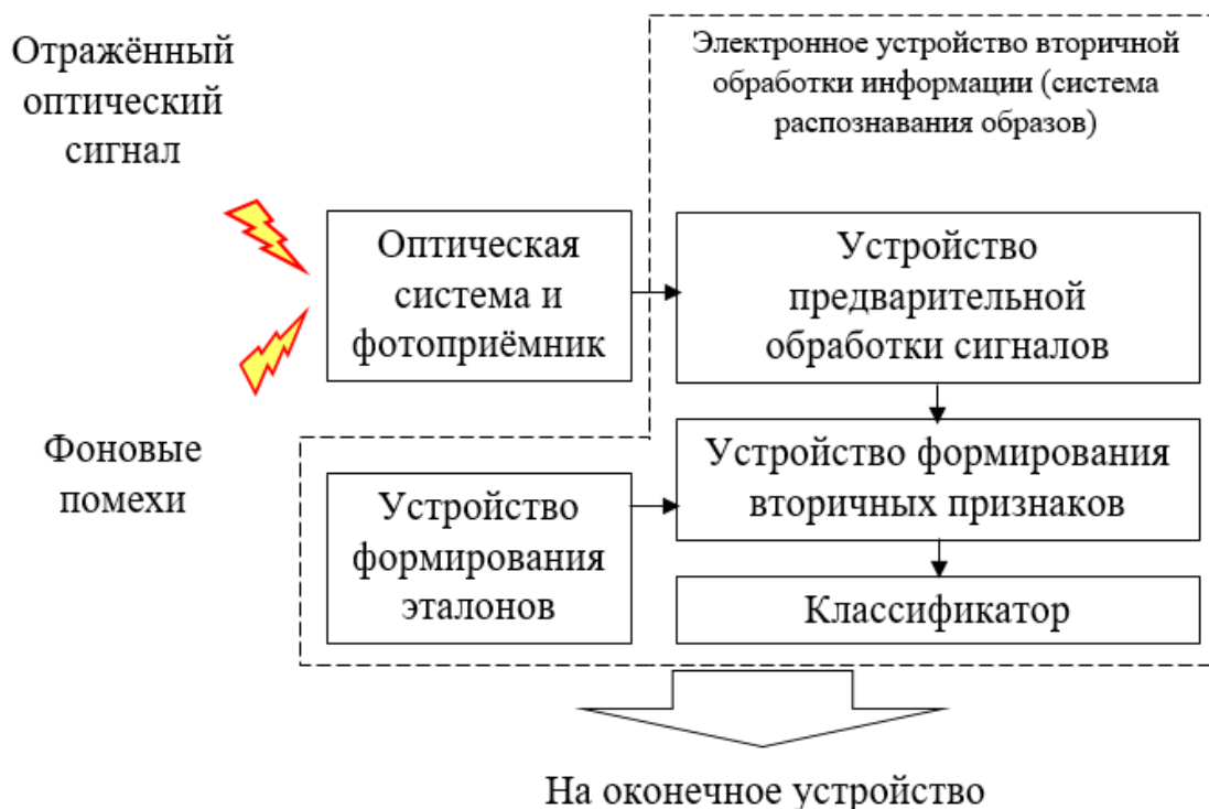
Рисунок 2 - Обобщенная структурная схема системы распознавания оптических образов
