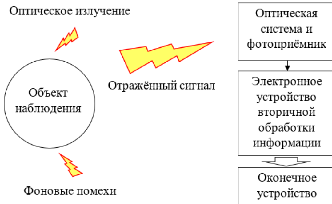
Рисунок 1 – Обобщенная структурная схема ОЭС обнаружения и распознавания объектов наблюдения
