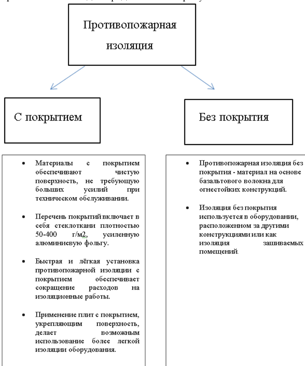
Рисунок 5 - Виды пожарной изоляции
