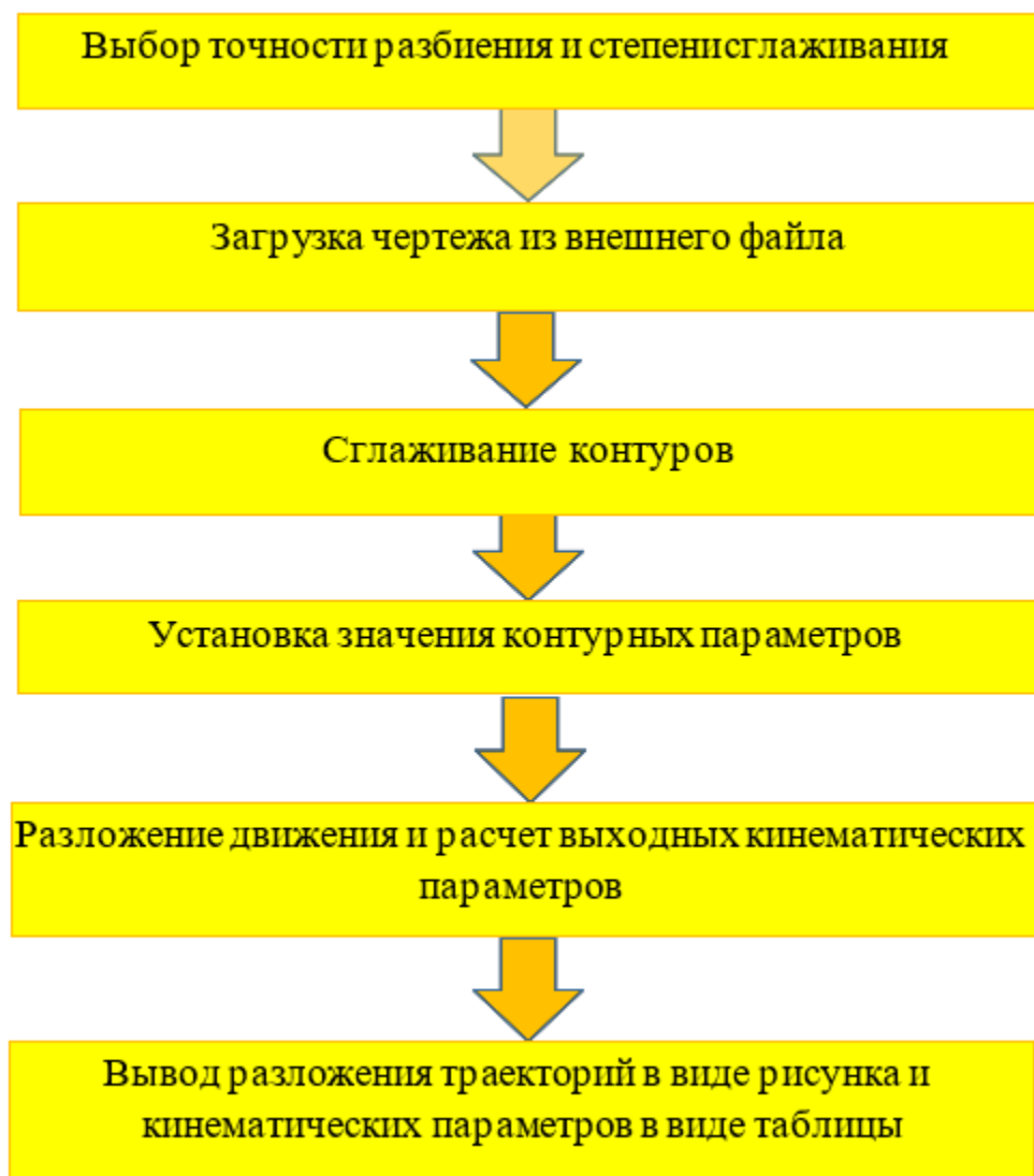
Рисунок 2. – Структурная схема математического обеспечения специализированного контроллера.
