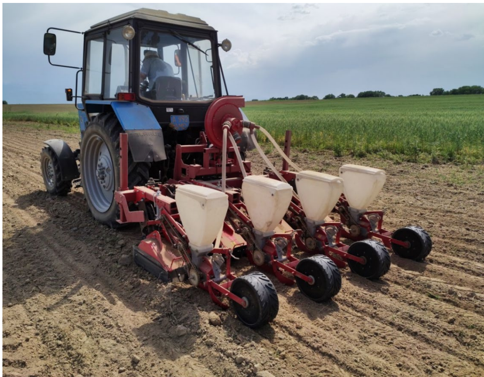
Рисунок – 2 Экспериментальный образец комбинированного агрегата для предпосевной обработки почвы и посева семян ФС-2,1 в работе
