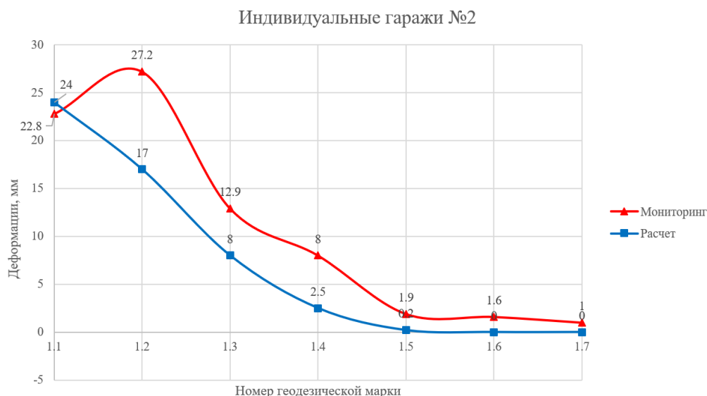
Рисунок 11. Совмещенные графики расчетных и фактических деформаций
