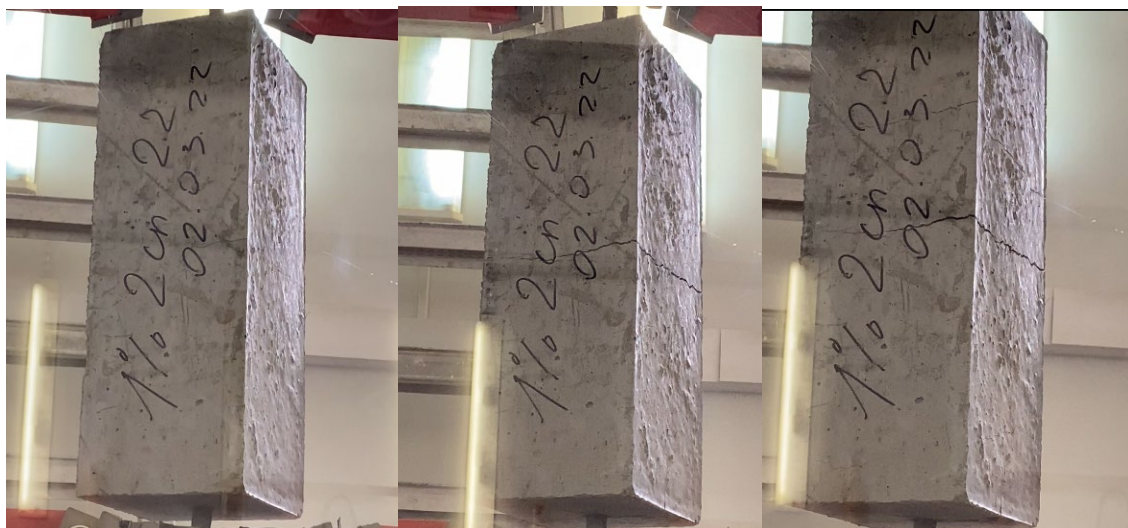
Рисунок 11. Разрушение сталефибробетонного образца (1% фибры), 2 схема (Коваленко А.А. 23.04.22)
