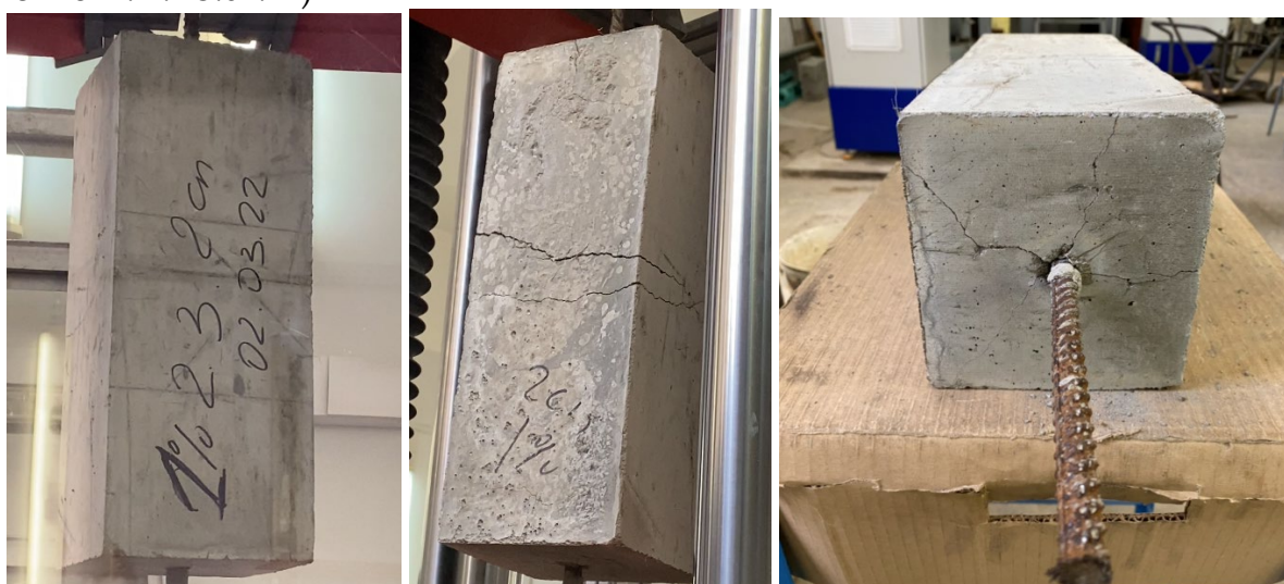
Рисунок 11. Разрушение сталефибробетонного образца (1% фибры), 2 схема (Коваленко А.А. 23.04.22)
