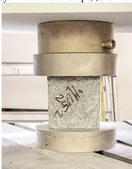
Рисунок 6. Испытание стандартных образцов на кубиковое сжатие (Коваленко А.А. 21.04.22)
