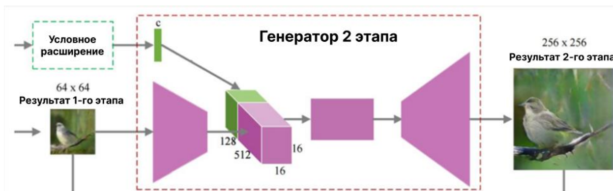
Рисунок 3. Генератор 2-го этапа
