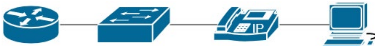
Рисунок 1 – IP – телефон как сетевой мост
