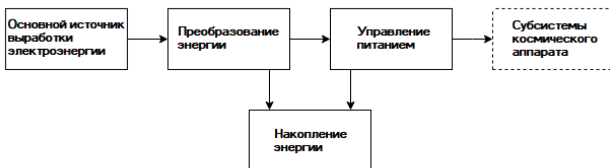
Рисунок 1. Структура системы электроснабжения космического аппарата ( https://www.researchgate.net/figure/Elements-of-a-Spacecraft-Electrical-Power-System_fig1_44256810 )
