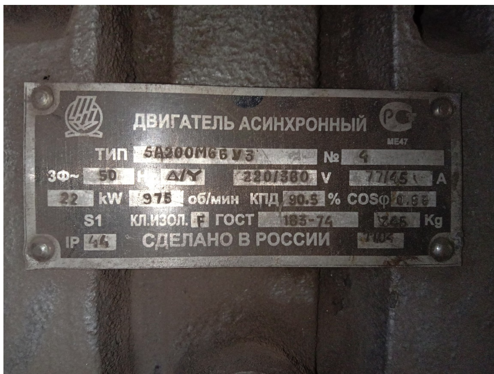
Рисунок 3. Шильдик электродвигателя 5А200М6ВУ3
