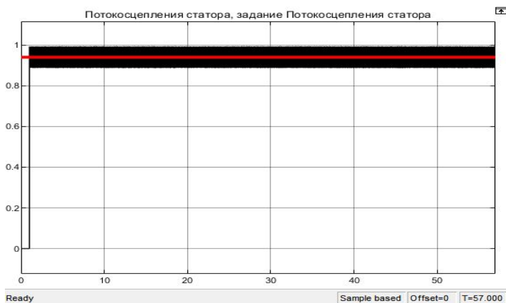
Рис. 15. График потоксцепления статора заданный (красный график) и фактический (черный график)
