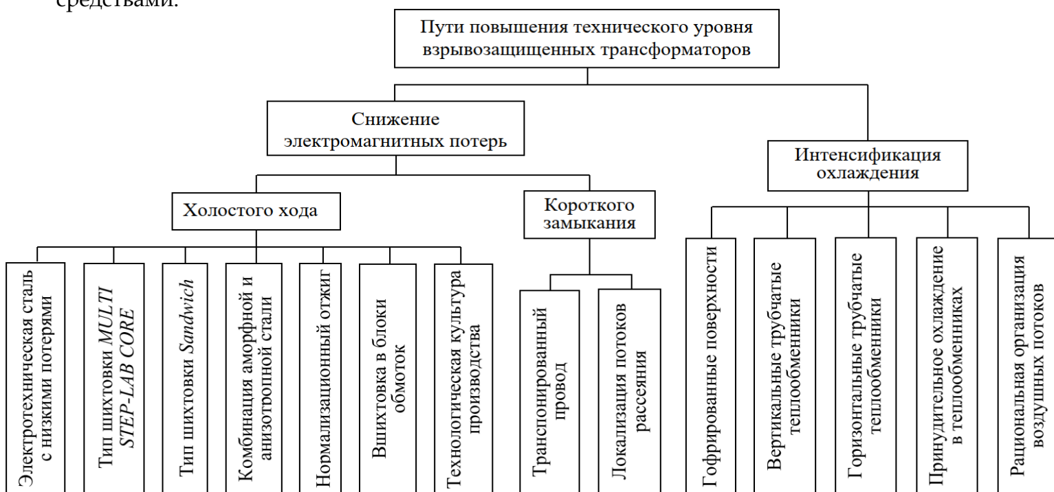
Рисунок. Пути повышения технического уровня взрывозащищенных трансформаторов
