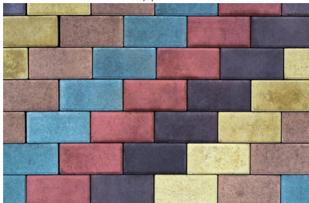
Рисунок 3 – Бетон с добавлением цветных пигментов.
