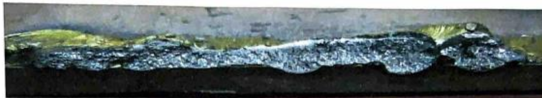
Рисунок 13 – сварной шов электрода марки ЭПС-АН1 при изломе
