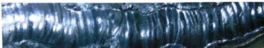
Рисунок 14 – Сварной шов электрода марки ЭПС-АН1 в разрезе (со снятым слоем воздушно – дуговой строжкой)
