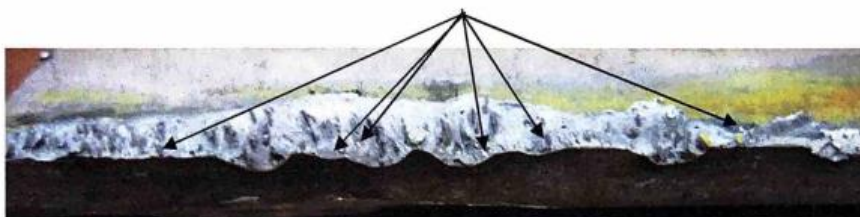
Рисунок 9 – Излом, выполненный по сварному шву. Исполнен электродами марки ЛКИ-1П
