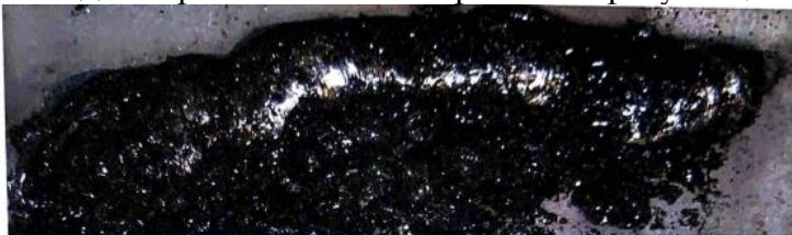
Рисунок 7 – Выделившаяся после сварки шлаковая составляющая электродов марки ЛКИ-1П
