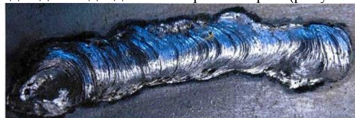
Рисунок 8 – Сварной шов электрода марки ЛКИ-1П после удаления шлаковой корки - есть внутренние поры, шлаковые включения отсутствуют (рисунок 9, 10).
