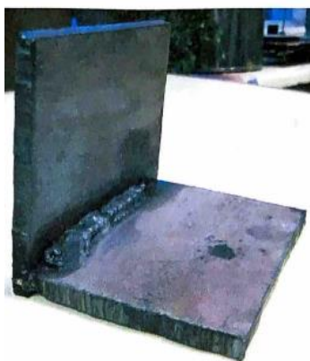
Рисунок 5 – Тавровое соединение с заваренным сварным швом
