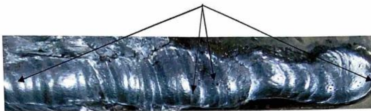
Рисунок 10 – Исполненный электродами марки ЛКИ-1П сварной шов после снятия слоя воздушно – дуговой строжкой
