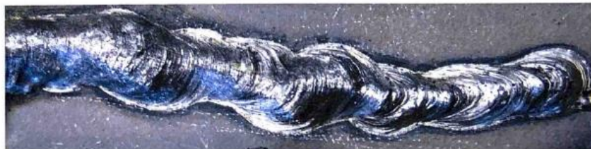
Рисунок 12 – Сварной шов электродам марки ЭПС-АН1 после удаления шлаковой корки
