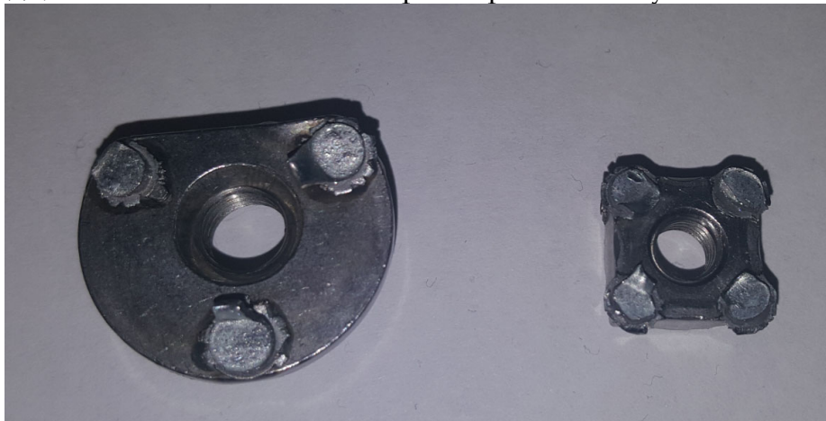
Рис. 6 Вид гаек после разрушения соединения.
