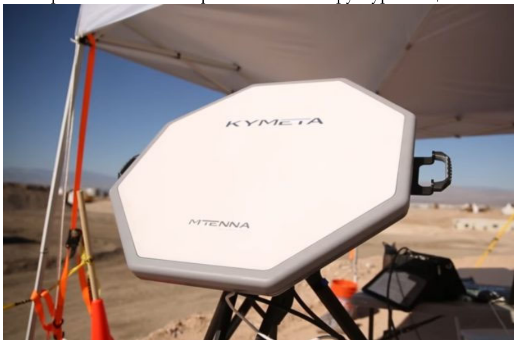
Рисунок 2. Плоскопанельные антенны Kymeta Hawk [8]
