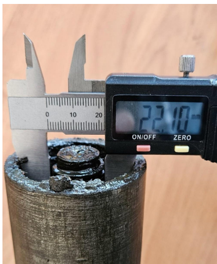
Рисунок 12. Для измерения диаметра винта, тиски были предварительно разобраны. Составлено автором.
