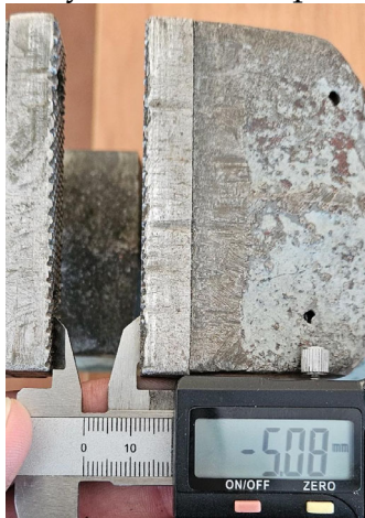
Рисунок 11. Измерение шага резьбы. Один полный оборот рукоятки в среднем равняется перемещению губок тисков на 5 мм. Составлено автором.
