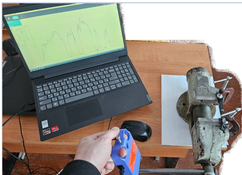
Рисунок 13. Для количественной оценки прочности образцов использовался цифровой датчик силы с пределом измерений 80 Н. Составлено автором.
