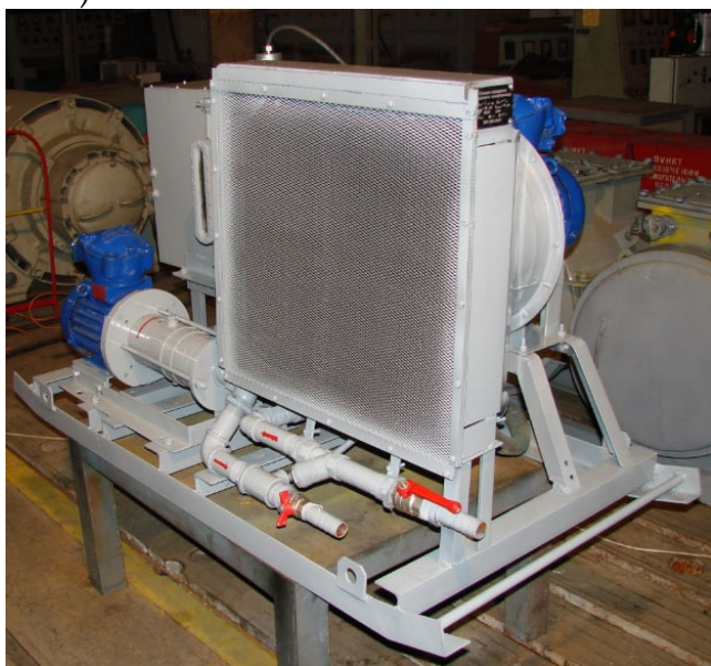
Рисунок 1 – Станция охлаждения СОРЭ 4-20
