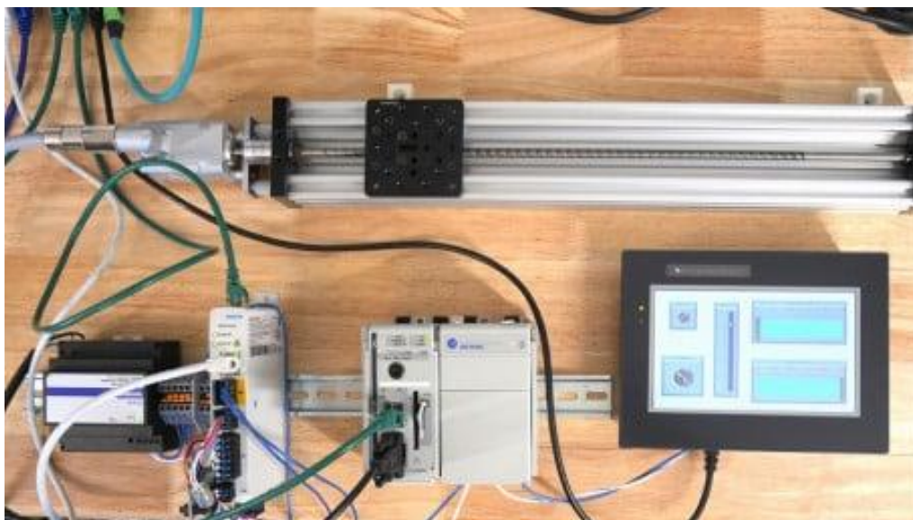
Рис. 2 - Реализация аппаратного модуля PLC для управления ректификацией [4]
