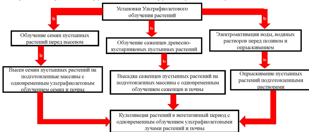
Рис. 3. Схема использования Установки ультрафиолетового облучения пустынных растений при проведении работ по культивированию пустынных растений.
