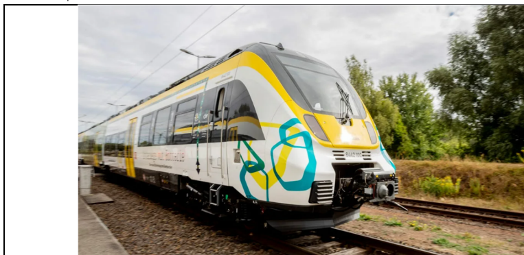
Рис. 8. [14]. Канадская машиностроительная компания Bombardier провела в Германии первую опытную поездку своего гибридного электропоезда с питанием от аккумуляторных батарей Talent 3. Он был построен в 1996 году, но первые рейсы с пассажирами начались только в ноябре 2020 года. Talent 3 может развивать максимальную скорость 160 км/ч. [15]
