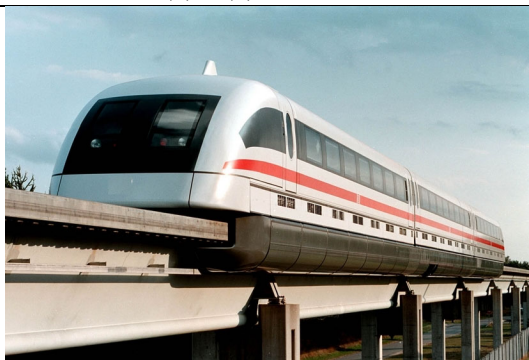
Рис. 7. [12] «Шанхайский маглев — первая в мире железнодорожная линия на магнитном подвесе. Соединяет станцию шанхайского метро «Лунъян Лу» с международным аэропортом Пудун и преодолевает расстояние 30 км за 8 мин 01 сек., разгоняясь до скорости 431 км/ч. Введена в эксплуатацию 1 января 2004 года. [13]
