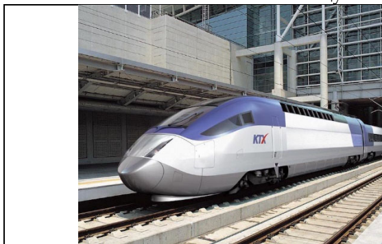
Рис. 6. [9] Южнокорейская сеть КТХ использует поезд КТХ-II, который работает на системе переменного тока. Введён в эксплуатацию в 2010 году. Поезд проходит через следующие города: Сеул, Пусан, Тэгу, Кванджу, Чонджу и Пхенчхон. Максимальная скорость составляет 300 км/ч. [10]
