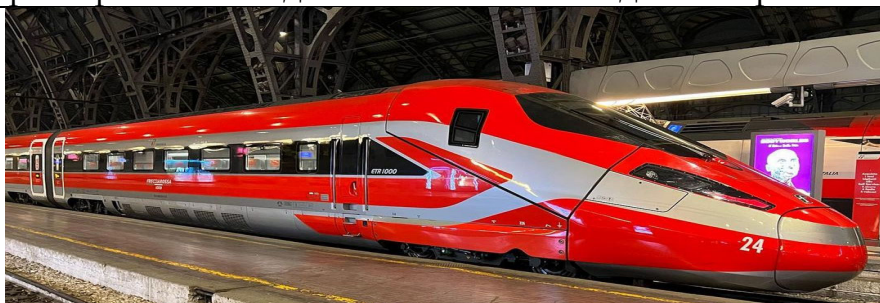
Рис. 4. [6] Примером высокоскоростного поезда с использованием систем постоянного тока является итальянский Frecciarossa, 2008 года производства. Он обслуживает всю Италию, соединяя Рим, Милан, Флоренцию, Болонью, Неаполь, Турин и Венецию. Максимальная скорость Frecciarossa составляет 300 км/ч. [7]
