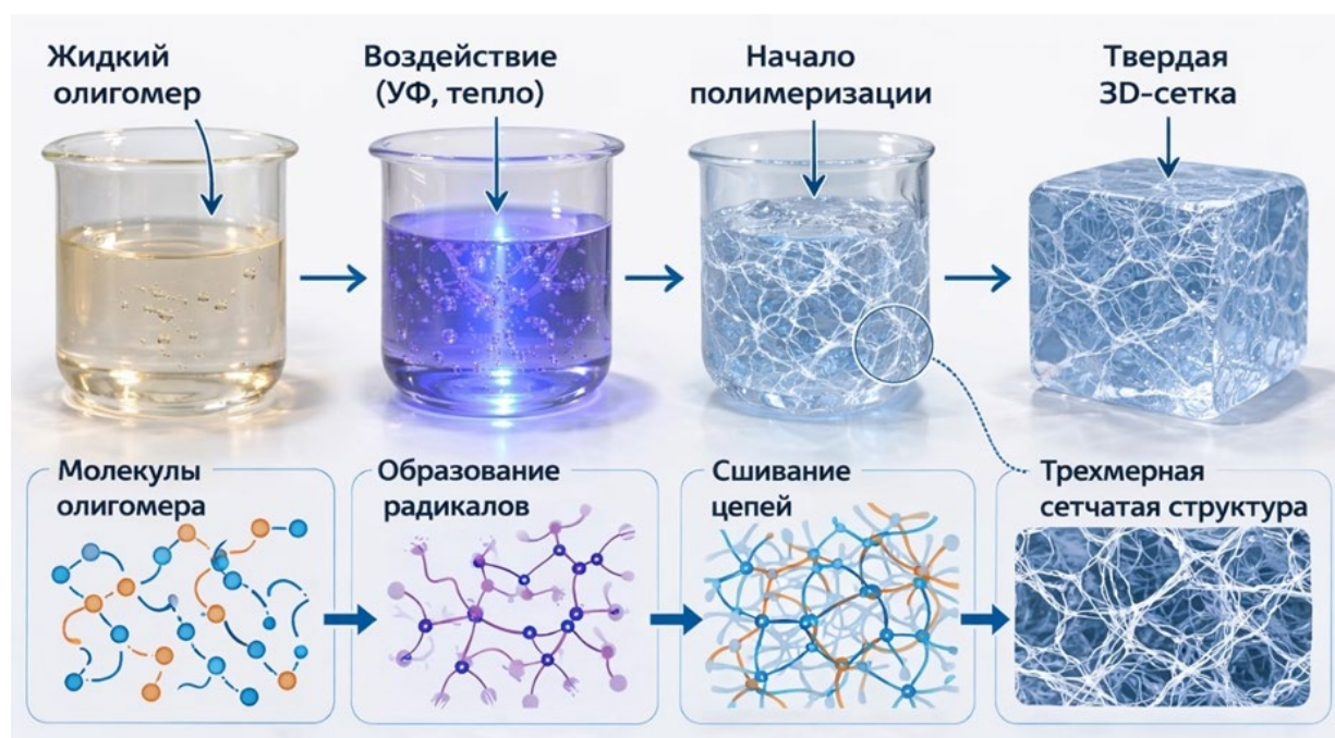
Рис. 1. Превращение жидкого олигомера в твердую трехмерную сетку
